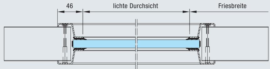
Standard-Verglasung mit aufgesetztem Edelstahl-Profil ohne sichtbare Verschraubung auf der Bandseite für Rechteck- und Rundverglasung
