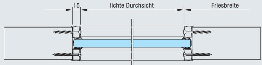
Optionale Verglasung mit stumpfem Edelstahl-Profil für Rechteckverglasung (nur bei MZ, T30/El<sub>2</sub>30, nur in V2A, 1.4301 möglich)
