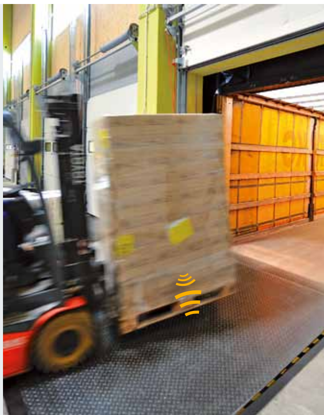
Автоматическая регистрация передвижения груза, просто во время проезда по перегрузочному мосту.
